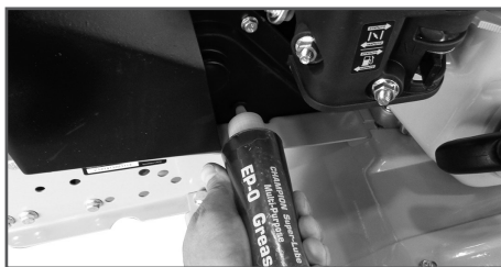
Рис. 25 Добавление смазки в редуктор
