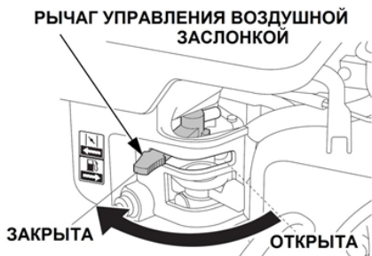
Рис. 14 Рычаг управления воздушной заслонкой (вид сверху)
