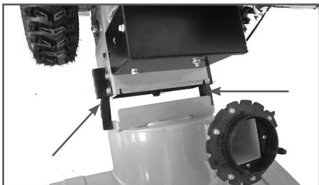
Рис. 2 Стыковка снегоотбрасывателя
