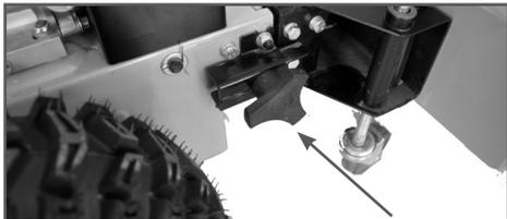
Рис. 1 Отсоединение щетки от корпуса машины
