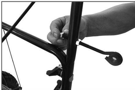
**Рис. 7** Монтаж кронштейна рычага поворота желоба
